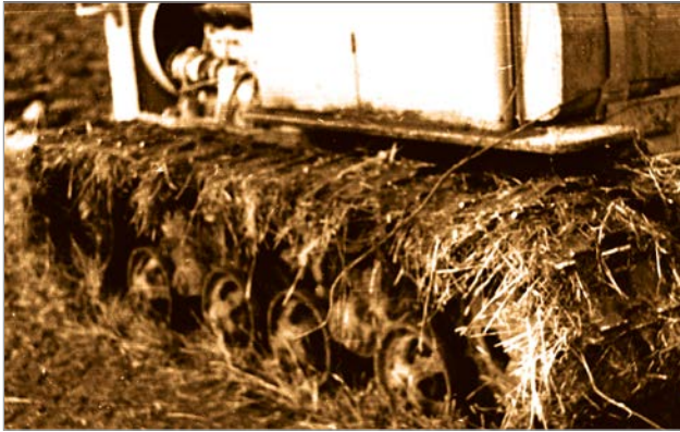
Szántóföldi vizsgálaton a DT-413 traktor, 1952 (A láncaltpal öntisztulása még nem megfelelő!)
