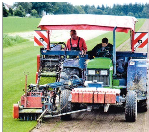
A 40 cm-es felszedési szélességet garantáló sorvezető-tapogató
