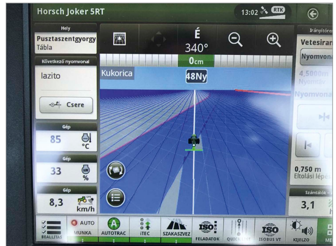
11. ábra Szakaszevezérlés munka közben
