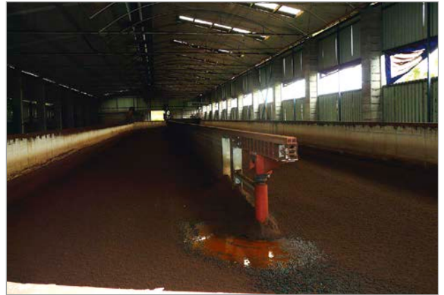
A baromfitrágya fermentálása egy betonkádban történik, folyamatos keverés mellett
