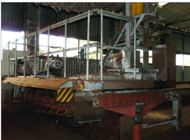
A betonkádban keverőberendezés található, amely folyamatosan forgatja a trágyát az optimális száradás és konzisztencia elérése érdekében
