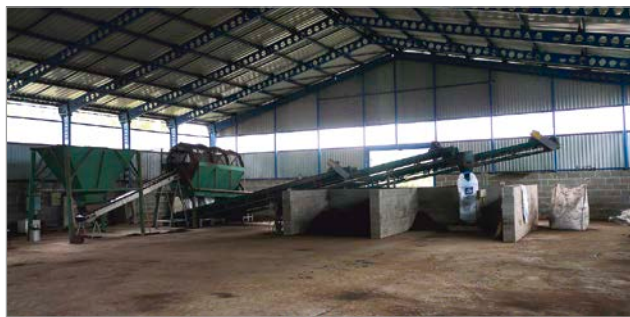
A kész fermentált baromfitrágát rostálják, majd zsákolják
