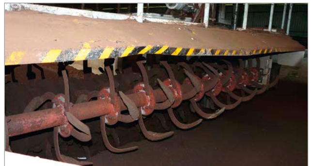
A betonkádban keverőberendezés található, amely folyamatosan forgatja a trágyát az optimális száradás és konzisztencia elérése érdekében
