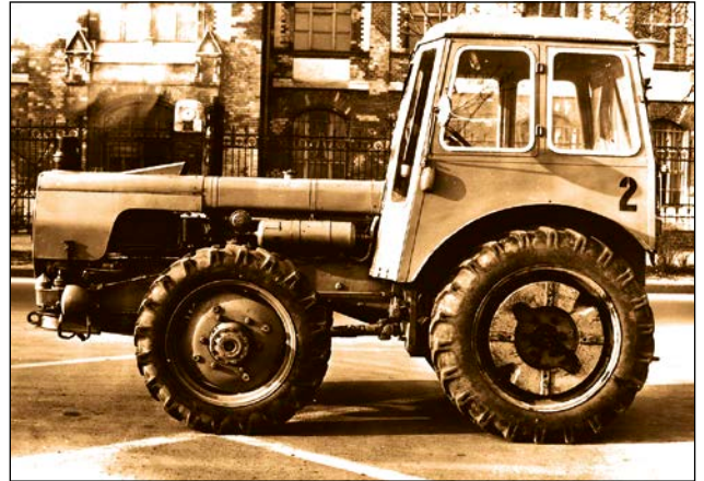
Az UE-28 típusú traktor a Kismotor és Gépgyár SF-2 léghűtéses motorjával, 1966
