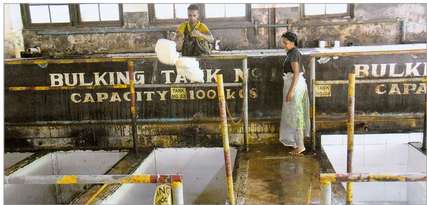
A latextej beoltása – a „Dry Rubber Content” kicsapatása az oltókádokban
