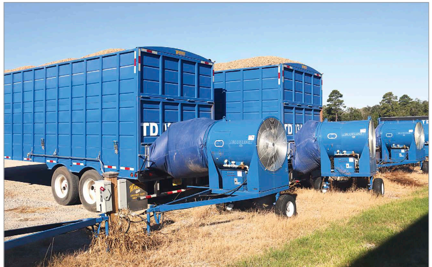
A betakarított földmogyoró termés mesterséges szárítása kamrás mobilszárítókkal
