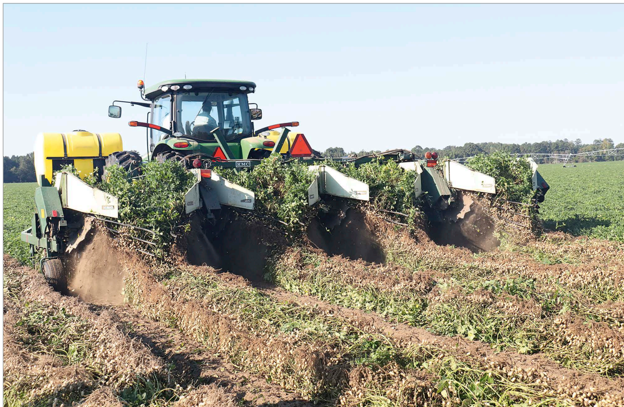
A nyűvőgépek két sorról képeznek egy rendet, ahol alul helyezkedik el a szár és felette a száradó termés
