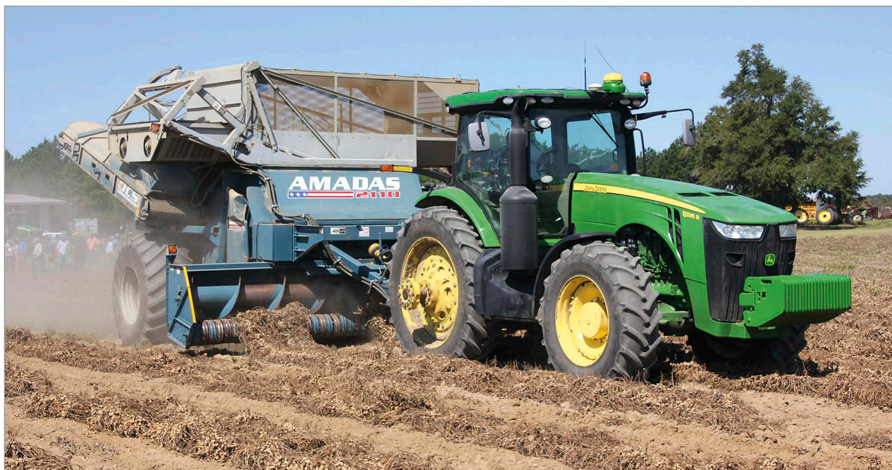
Az amerikai gyártmányú AMADAS 2110 vontatott mogyoróbetakarító kombájn egyszerre négy rendet képes felszedni
