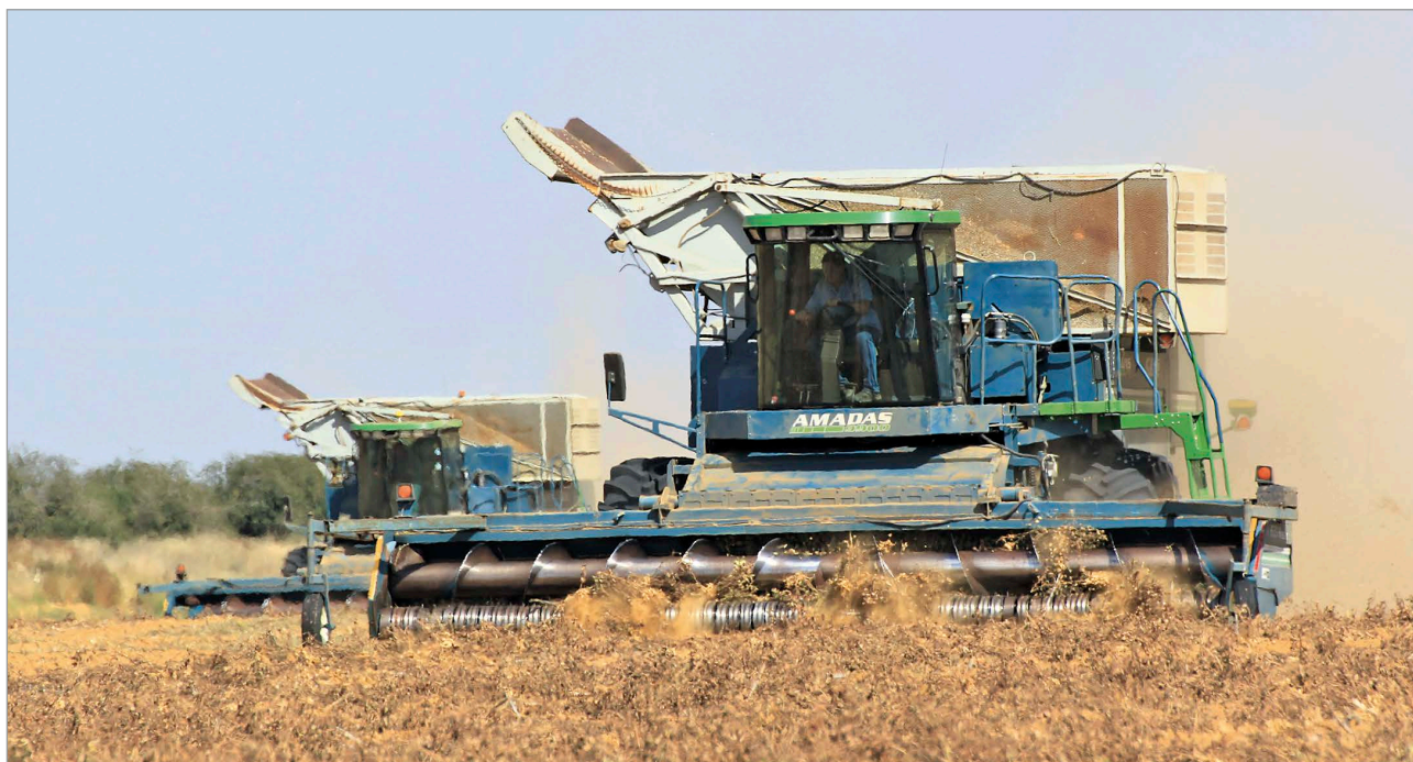
Az AMADAS gyár magajáró, magas billentéssel üríthető magtartállyal készülő 9900-es típusú kombájnjai
