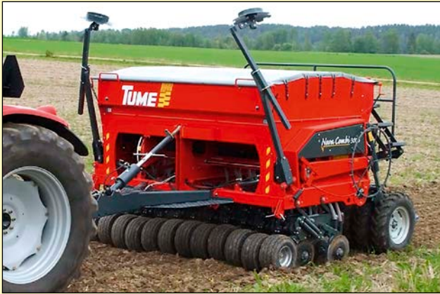
1. ábra Tume Nova Combi 3000 mechanikus vetőszerkezetű direkt vető gép
