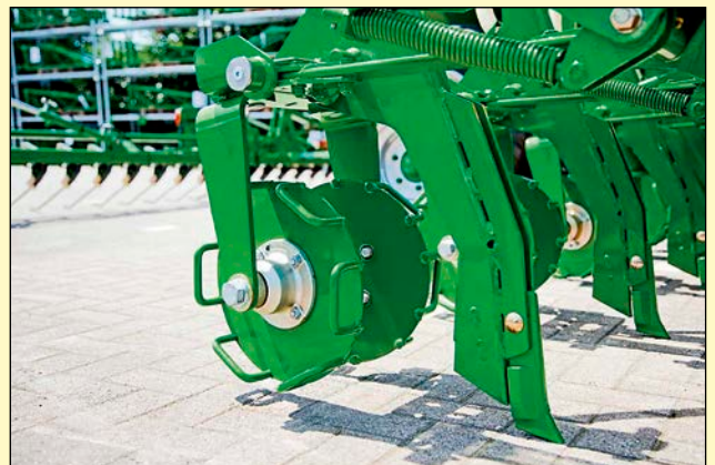
4. ábra Késes vetőcsoroszlyák direkt vető gépen
