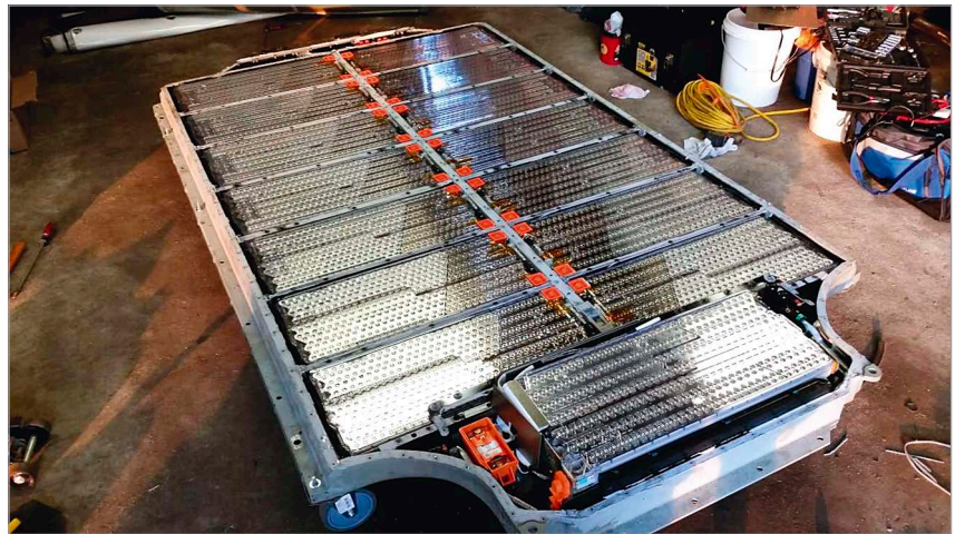
A Tesla Model S akkumulátorcsomag a fedél eltávolítása után, 18650 cella, 85 kWh energiataralommal – Forrás: https://qnov.com/peek-inside-the-battery-of-a-tesla-model-s
