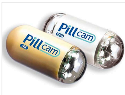
3. ábra A Given Imaging által kifejlesztett M2A lenyelhető képkalkotó kapszula (Forrás: www.givenimaging.com)
