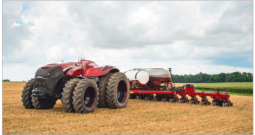
1. ábra A CASE IH Magnum CVX traktor vezető nélküli változata (Forrás: ww.investkft.hu)
